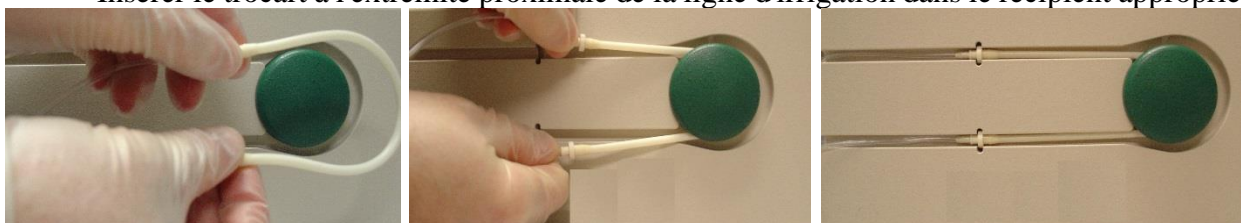
Figure 3 - Mise en place de la tubulure de pompe en silicone
